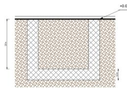
4 Schnitt Betonkanal
